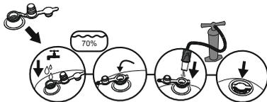
3. Öffnen Sie die Sicherheitsventile und blasen Sie die Teile einzeln auf. Schließen Sie die Ventile nach dem Aufblasen sorgfältig. Die Luftpumpe liegt nicht bei. **HINWEIS:** Blasen Sie nicht zu viel Luft auf. Verwenden Sie keinen Verdichter oder Druckluft.
